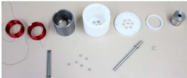
Eine Anforderung an dieses Unterwasserfahrzeug besteht darin, dass es sich im Störfall (z. B. Manövrierunfähigkeit) aus großer Tiefe bergen lässt. Für dieses Einsatzszenario wurde ein Sicherheitsmechanismus konzipiert, der durch einen Aktor ausgelöst wird. Hierfür wurden im Rahmen des Aktorikprojekts zwei elektromagnetische Linearaktoren mit unterschiedlicher Leistung entwickelt. Dabei bestanden folgende Anforderungen an deren Konstruktion:
