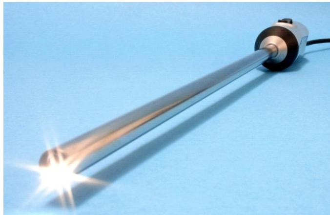
Bei der Entwicklung eines LED-Endoskops gilt es zunächst zu entscheiden, an welcher Position der Einbau von Lichtquellen sinnvoll ist. Bei der Montage im Griff ist die Abfuhr der Verlustwärme über die Griffoberfläche relativ einfach. Dafür muss jedoch das Licht an die Spitze des Endoskops geleitet werden, wobei mit großen Intensitätsverlusten zu rechnen ist. Fügt man die Lichtquelle in die Endoskopspitze, treten diese Lichtverluste nicht auf. Allerdings ist es dann notwendig,
