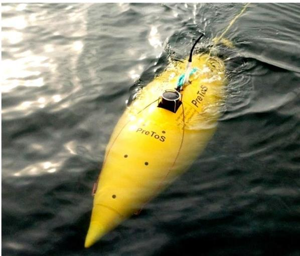
Im Unterschied zum ersten Prototyp erhielt PreToS eine strömungsoptimierte, bionische Pinguin-Form, so dass der Energievorrat der Akkumulatoren große Reichweiten bei Unterwasserfahrten in einer Tiefe von 6.000 Meter ermöglicht.
