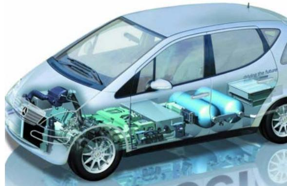
Betrieben wird die PEMFC mit reinem Wasserstoff, wobei eine Abgasemission entfällt. Mit einem vor geschalteten Reformier lassen sich auch andere Brennstoffe wie Erdgas oder Benzin verwenden. Dabei wird jedoch unter anderem Kohlenstoffdioxid freigesetzt. Hier fällt die Emission im Vergleich zu konventionellen Verbrennungskraftmaschinen allerdings wesentlich geringer aus.
