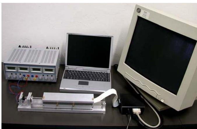
Zur qualitativen Beurteilung von Objektiven betrachtet man meist Kontrast und Auflösung, die sich mit der Modulations-Übertragungsfunktion (MTF) darstellen lassen. Dadurch ist es möglich, eine objektiv messbare Größe für die gesamte Abbildungsleistung des Objektivs zu finden. Mit Hilfe spezieller Software wird die MTF für unterschiedlich feine Strukturen ermittelt.
