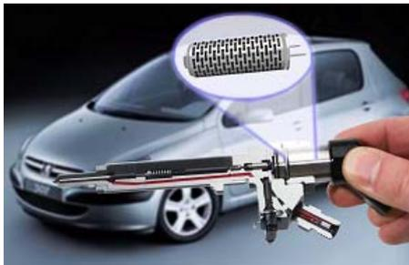
In jüngster Zeit werden Stapelaktoren als Massenprodukt zur Steuerung des Einspritzvorgangs in Common-Rail-Dieselmotoren eingesetzt (Bild links, Piezoinspritzdüse von EPCOS). Sie spielen auch in der aktiven schwingungsdämpfenden Lagerung sowie zur Betätigung von Hubschrauber-Flaps unter dem Einsatz von mechanischen Wegverstärkern eine Rolle.
