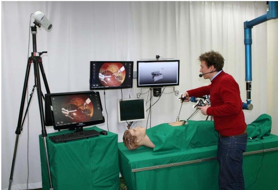
Hierzu wird ein aus mehreren Segmenten bestehender deckenmontierter Haltearm, mit dem sich das Endoskop fixieren lässt, durch den Operateur über dem liegenden Patienten in der gewünschten Lage arretiert. Das Endoskopsystem besteht aus einem Schwenkprismenendoskop, bei dem die Blickrichtung motorisch variierbar ist, einem Rotationsmodul zur Drehung um die Längsachse und einer HD-Kamera mit Elektromotoren für die Zoom- und Autofokusfunktion.
