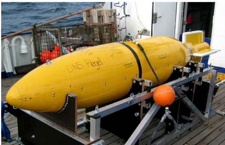
Nach dem Bericht über die Erprobungsfahrten konzentrieren wir uns auf ein spezielles Detail: das druckneutrale Lage-trimmsystem. Das Einpendeln des Boots erfolgt automatisch, indem eine schwere Flüssigkeit zwischen elastischen Körpern in Bug und Heck gepumpt wird. Ein Sensorsystem überwacht die Überdehnung der Volumenkörper.
