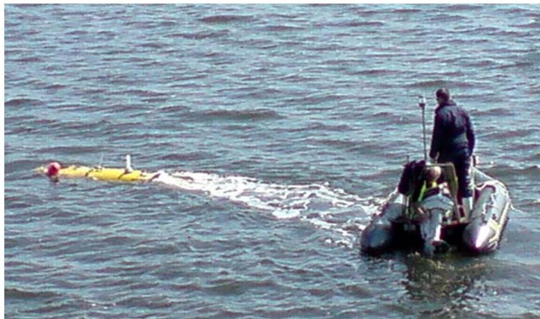
Anhand von Bildern und Videoaufnahmen wird über die Ergebnisse der Fahrversuche im Rostocker Hafenbecken und der anschließenden Freifahrterprobung in der Ostsee berichtet. Dabei wurde das Verhalten des U-Boots in Kurven- und Geradeausfahrten sowie bei Tauchgängen mit jeweils unterschiedlichen Antriebsgeschwindigkeiten untersucht.
