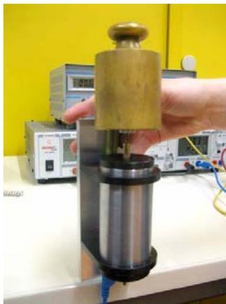
kraft zur Lorentzkraft dienen Druckfedern, so dass die Läufer stabil positioniert werden können.
